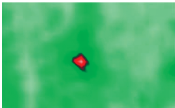
Рис. 14. Визуализация объемной трещины на частоте седьмой гармоники
